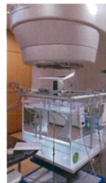
図1. 水ファントムを使用した線量測定
